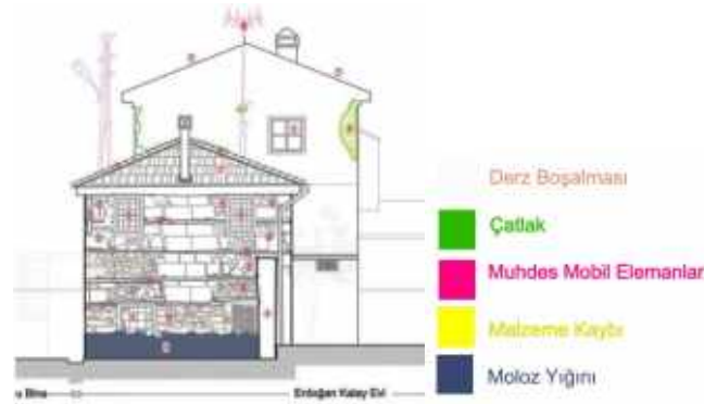
Resim 30. Kuzey Cephe Bozulma Analizi 33
