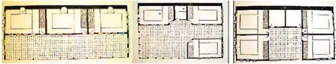
Resim 2. Sıra Odalı, Köşe Sofalı ve Üç Tarafı Odalı Dış Sofalı Plan Tipi (Eldem, 1968)
