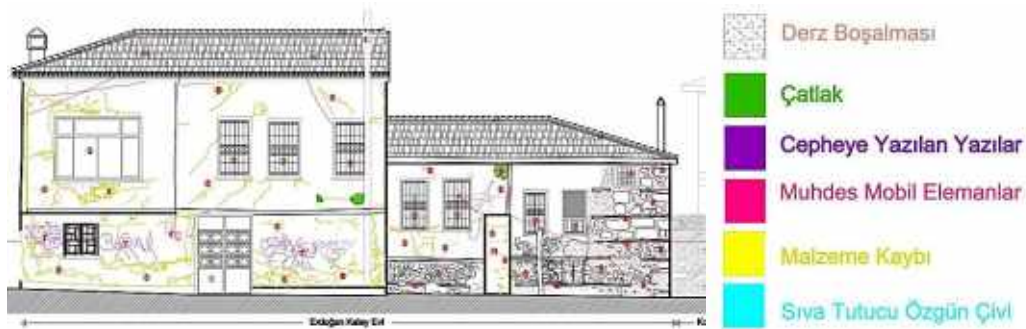
Resim 27. Doğu (Giriş) Cephesi Bozulma Analizi 30
